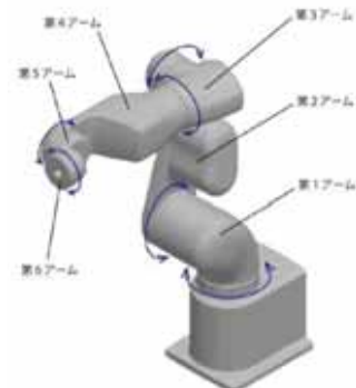
【各部名称および可動部の 動作を示す参考図】
